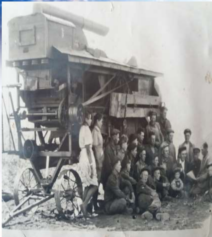
Віялка “ВІМ” – зерноочисна машина
